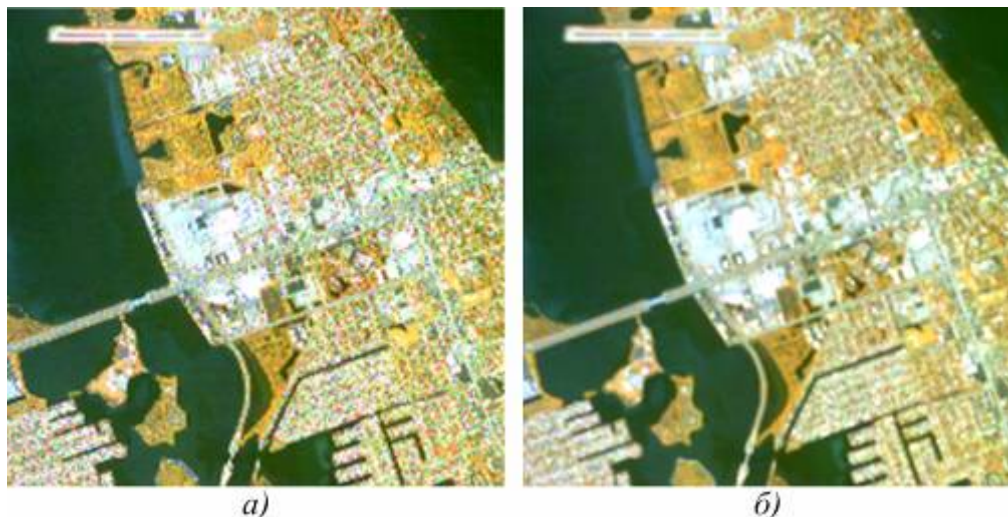
Рис. 3. Фрагмент изображения в масштабе 1:16: а – без интерполяции, б – с интерполяцией
